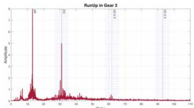
شکل ۵ آنالیز مرتبه دنده ۳ در حالت افزایش سرعت
