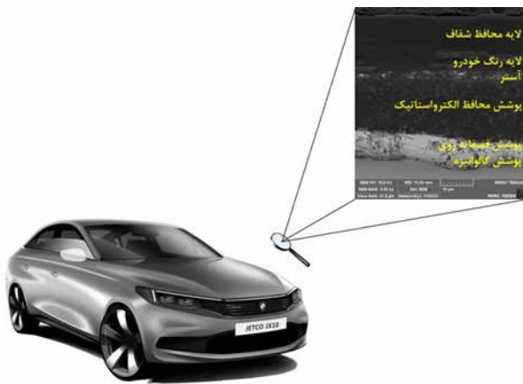
شکل ۲: لایه‌های مختلف پوشش و رنگ بدنه خودرو
